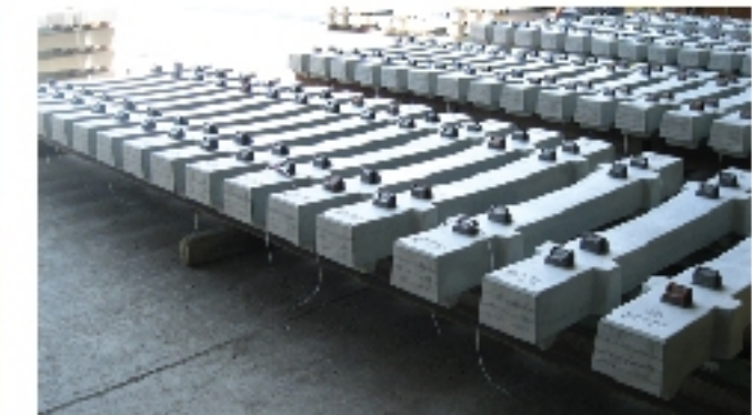
Tà vẹt thi công tuyến Metro Tp.HCM
